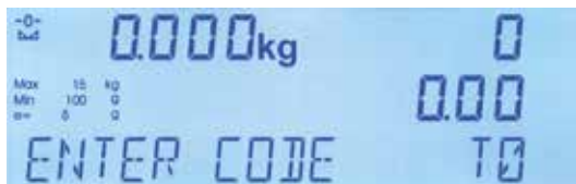
Display LCD retroiluminado
