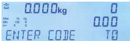
Display LCD retroiluminado
